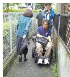
道路幅員は1.2mで、沿道建築物との一体的な整備と、水路接続部での勾配緩和や見通しの改良が必要な市道（L2-2号線）
