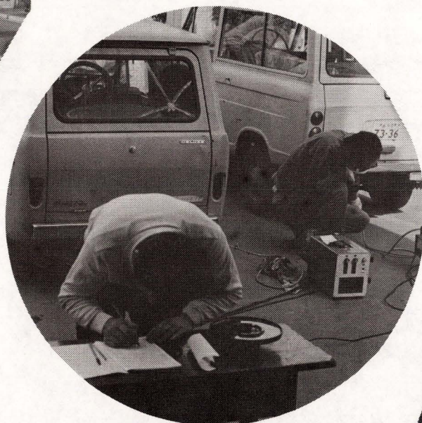
排 気 ガ ス 検 査
